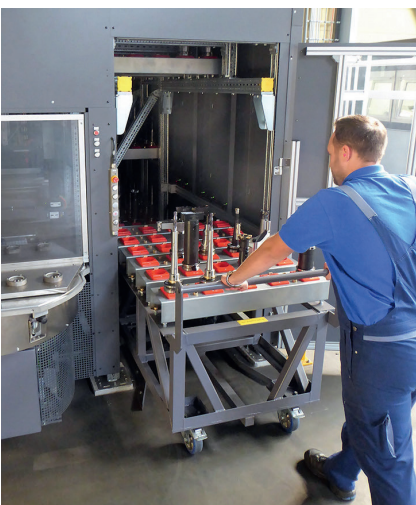
4 Das automatische Werkzeugmagazin verwaltet nicht nur einzelne Werkzeuge, sondern auch den gesamten Werkzeugwagen für einen Auftrag © Rile
